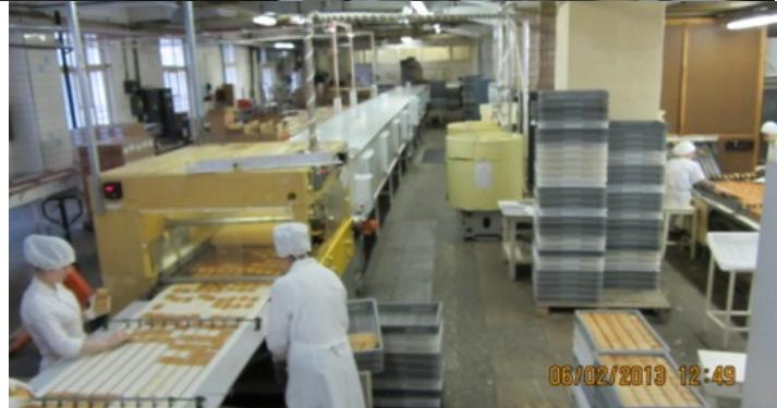
При автоматизированном производстве печенья можно использовать метод изогоризонтальной конвейерной системы с транспортером,
